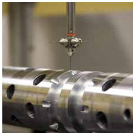
Eine Präzisionsmessmaschine überprüft die Maßhaltigkeit eines Hydraulikbauteils bis auf ein \mu (0,001 mm) genau.
