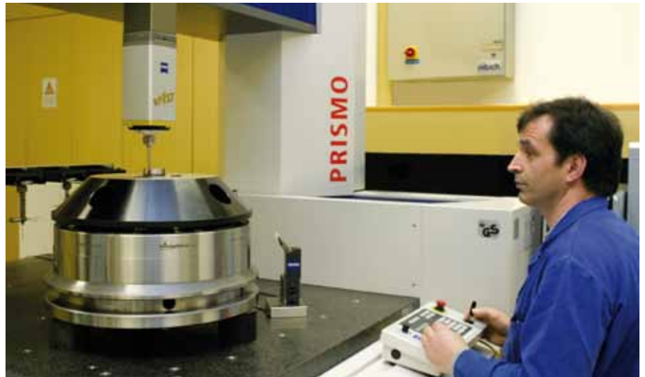
Ein Königdom® für die Fertigung von Flugzeugtriebwerken auf dem Prüfstand: Mit einer hochpräzisen Messmaschine wird die Genauigkeit des Spanndorns überprüft und dokumentiert.
