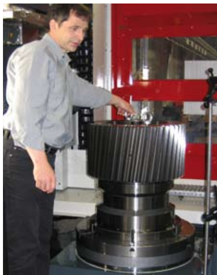
Königdorn®-Spannwerkzeug Typ E mit einem Spanndurchmesser von 360 mm. Bei dem zu bearbeitenden Werkstück – einem Zahnrad mit einem Außendurchmesser von 1.000 mm und einem Gewicht von 1,2 t – wird ein Rundlauf im Teilkreis der Verzahnung von \leq 0,01 mm erzielt.
